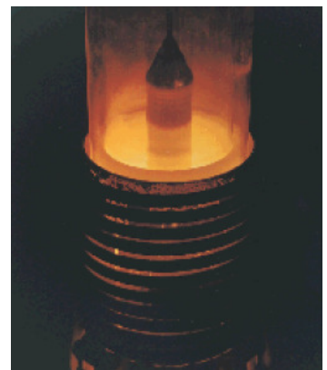
HPGe Produktion Ziehen des Kristalls
