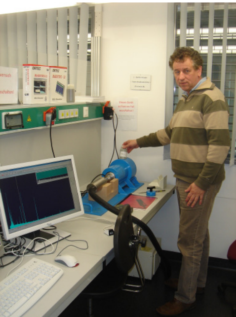
Abb.: Die Umweltproben werden in dieser einfachen Bleiburg gemessen, die den Untergrund ausreichend unterdrückt. Prof. Krause-Rehberg ist gerade dabei, eine Bodenprobe aus dem Mansfelder Land einzubauen.
