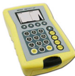
Die Ausstellung neuester Meßgeräte rundet das Seminar ab. ORTEC hat seinen neuen DigiDart-LF vorgestellt, ein digitales Spektrometer für die In-Situ Anwendung.
