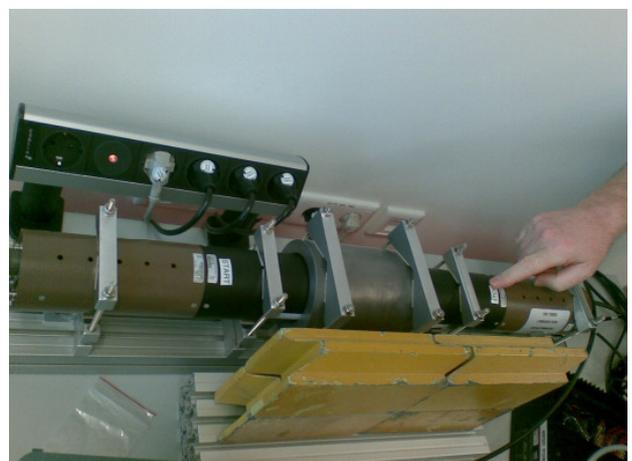
NaI-Szintillationsdetektoren mit Positronenquelle und Bleiabschirmung
