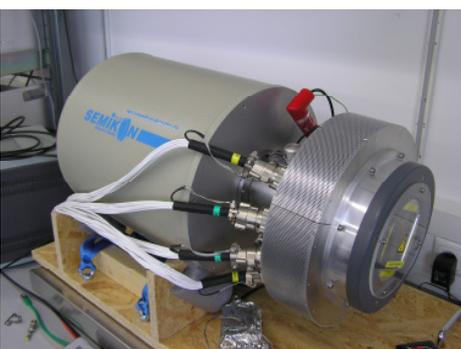
Das fertige Germanium-Detektorsystem besteht aus dem Detektor, dem Kryostaten und den 128 ladungsempfindlichen Vorverstärkern. Das System wird bei LN<sub>2</sub>-Temperatur betrieben.
