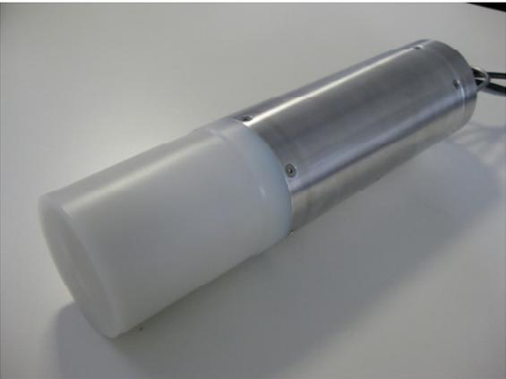
Durch die Verwendung einer Kunststoffendkappe, konnte, im Vergleich zu einer Ausführung aus Aluminium (die Endkappe hätte dann mindestens 2mm Wandstärke), eine deutliche Verbesserung der Transmission erzielt werden:
