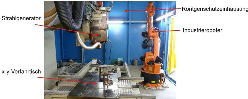
Abb.1: Überblick Versuchsaufbau mit Strahlgenerator, Verfahrtisch und Roboter
