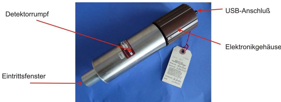
Abb.2: Szintillationsdetektor mit ORTEC MCA DigiBase für die digitale Pulsverarbeitung
