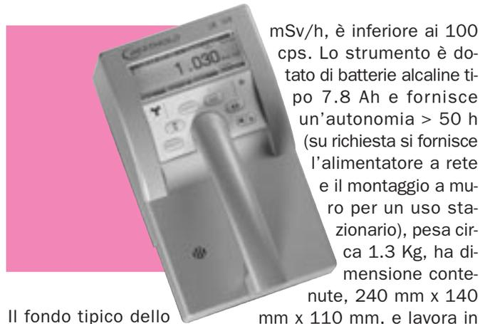
Il fondo tipico dello strumento è circa 0.1 cps per il canale alfa e 15 cps circa per il canale beta, mentre si hanno le seguenti efficienze:
