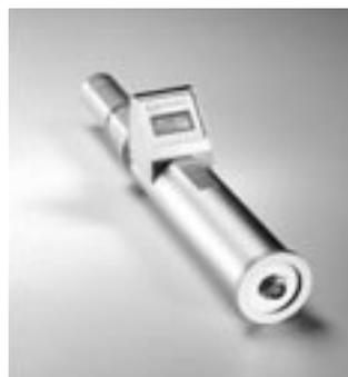
energia che varia da 30keV a 1,3MeV e rateo di dose da 50nSv/h a 50mSv/h. Il fattore di calibrazione è pari a 0,214 uSv/h per cps. Le unità di misura sono selezionabili per la lettura in Sv o rem.
