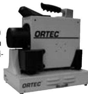
**Il sistema è inoltre dotato di un rivelatore He-3 per neutroni e di un computer palmare per la gestione dello strumento e della memorizzazione dei dati. Può essere connesso al PC mediante una porta USB ed è compatibile con i software Ortec qualitativi e quantitativi.**
